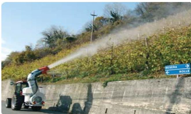
Un trattore con atomizzatore a cannone, al lavoro dalla strada (operazione espressamente vietata dai regolamenti)
